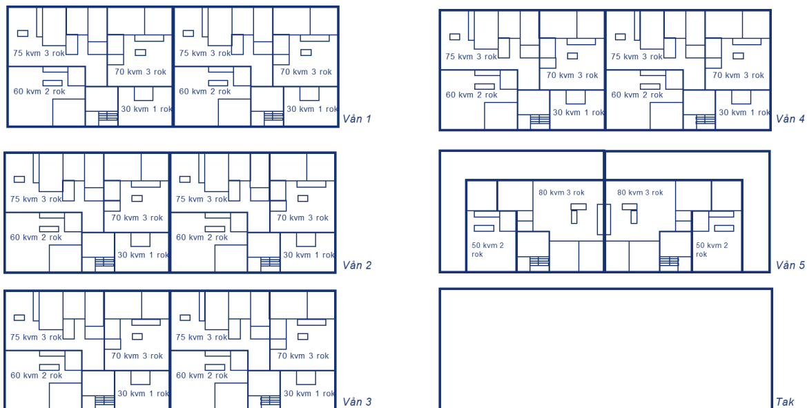
Figur 21: Uppskissad tänkt planlösning för det fiktiva flerbostadshuset. Två trapphus, fyra lägenheter per trapphus och totalt ca 500 kvm BTA per plan.
